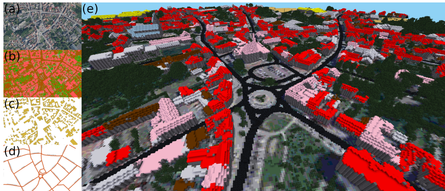
FIGURE 1. Exemple sur le territoire de Loos-en-Gohelle. Sources de données IGN utilisées : (a) BD ORTHO®, (b) LiDAR HD, (c) et (d) BD TOPO®. (e) Capture d'écran du rendu dans Minetest
