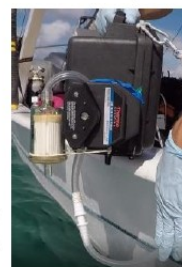
Placement de la capsule sur la tête de pompe
