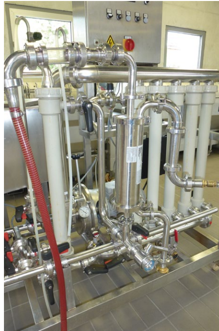
Abb. 9: Membrankontaktor am Ausgang des Cross Flow Filters ( www.inwag.de )
