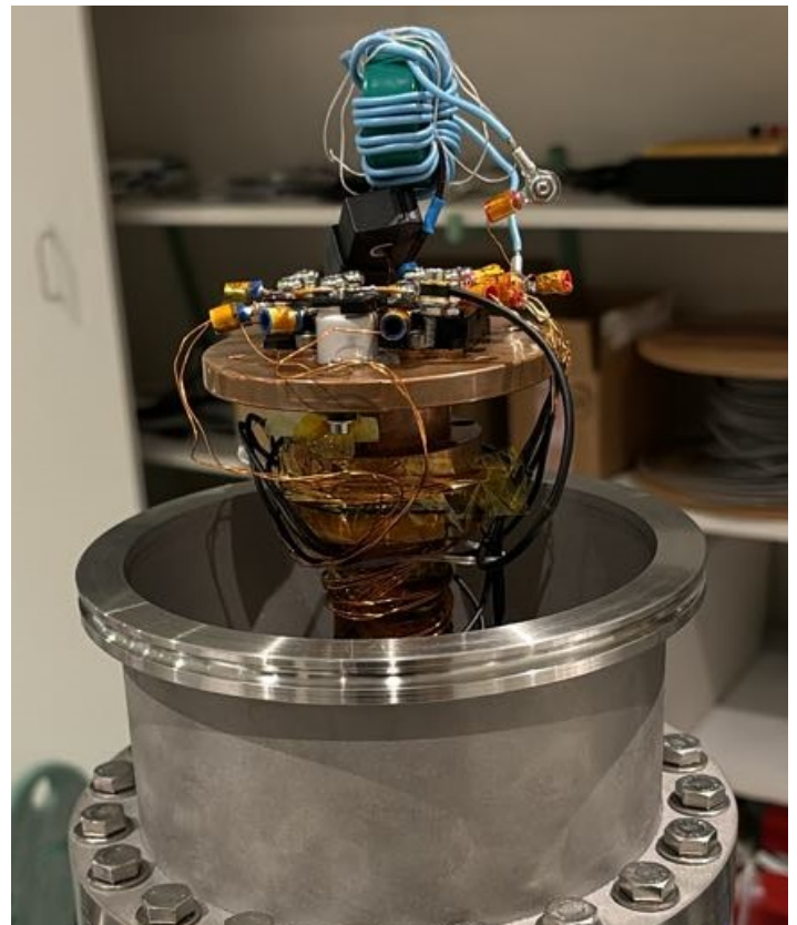
FIG. 1. Composants de puissance sur la tête froide du cryocooler.
