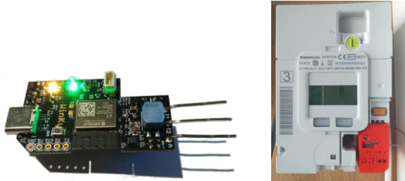
Fig. 2. ERL Winky (gauche) et ERL installé sur un compteur Linky (droit)
