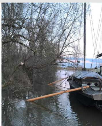
Scène d'hivernage. Des écouarts neufs sont transportés sur "Bouxafasse" puis amarrés à "La Tambouille" et piqués dans la rive submergée afin d'écarter le bateau du duit. Association Charpentiers d'Leau, Bréhémont (Indre-et-Loire), février 2024. © Maytraud, Basile.
