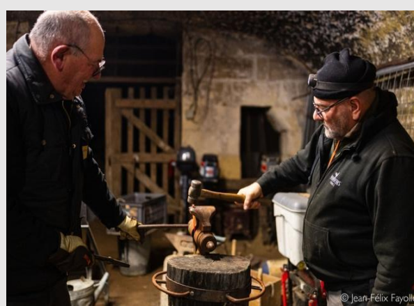
Fabrication des clous dans une forge. Bateliers de Saint-Etienne-de-Chigny (Indre-et-Loire). © Fayolle, Jean-Félix, 2024.
