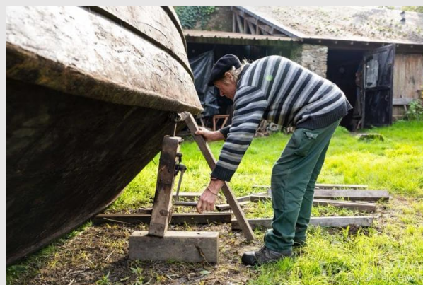
Opération de chavirage d'un bateau, sur un bordé, à l'aide d'un cric, pour intervenir sur la sole (réparation ou entretien). Chantier Minée, Saint-Jean-de-Boiseau (Loire-Atlantique). © Fayolle, Jean-Félix, 2024 (tous droits réservés).
