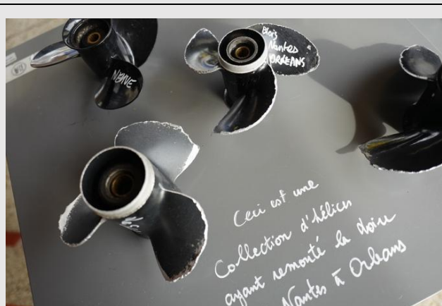
Hélices de bateaux ayant remonté la Loire de Nantes à Orléans avec marques d'altération. © Marmiroli, Bruno, Mission Val de Loire, 2023.
