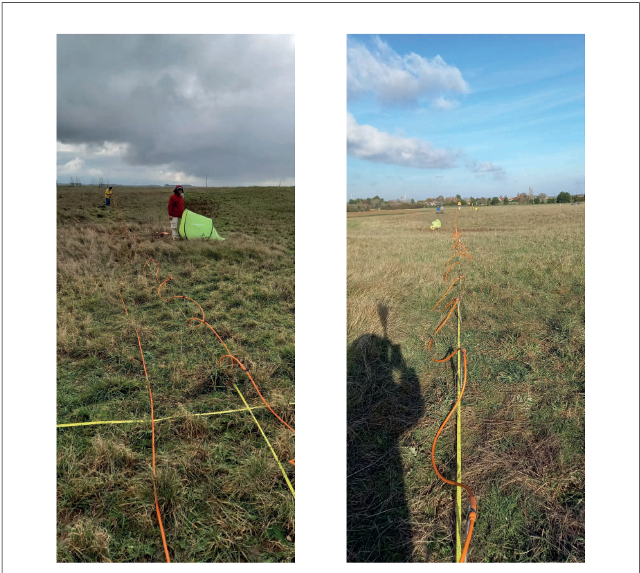
Fig. 20 – Clichés de la prospection de tomographie de résistivité électrique (ERT) sur la motte de Nids
