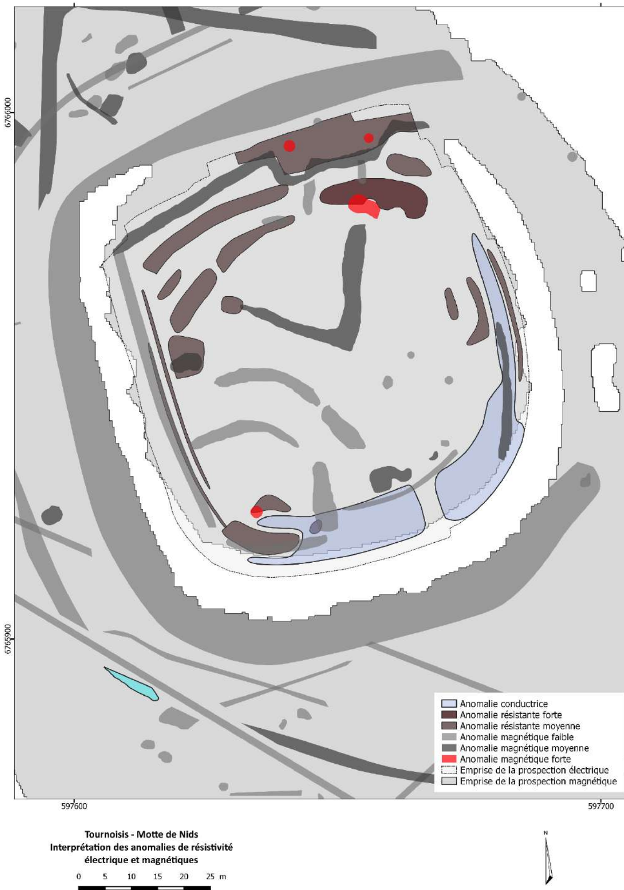
Fig. 18 - Interprétation géophysique des anomalies de résistivité électrique et magnétiques – zoom sur la motte (© Guillaume Hulin, Inrap 2024)
