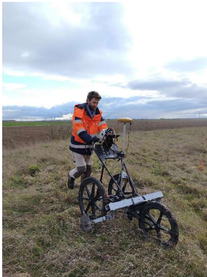
Fig. 15 - Système de mesure en continu de la résistivité électrique (© Marie Grousset, Inrap 2023)
