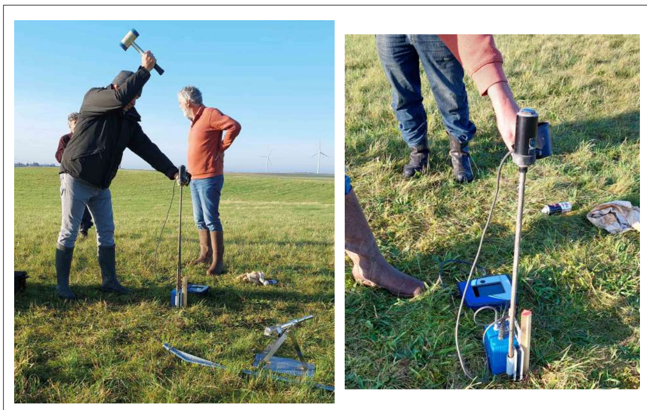
Fig. 35 – Dispositif de l'outil PANDA®
