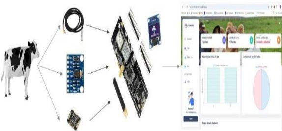
Figure 1 : Schéma d'architecture globale du système IoT pour la surveillance des vaches.
