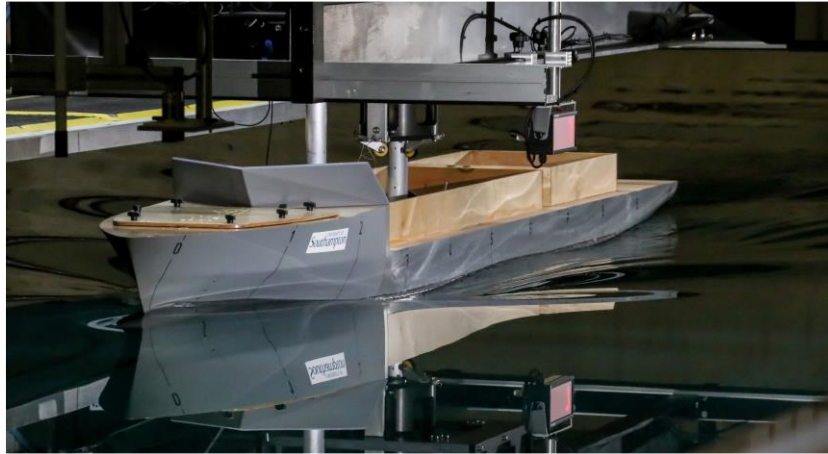
Figure 11 : Essais de validation avec la maquette KCS
