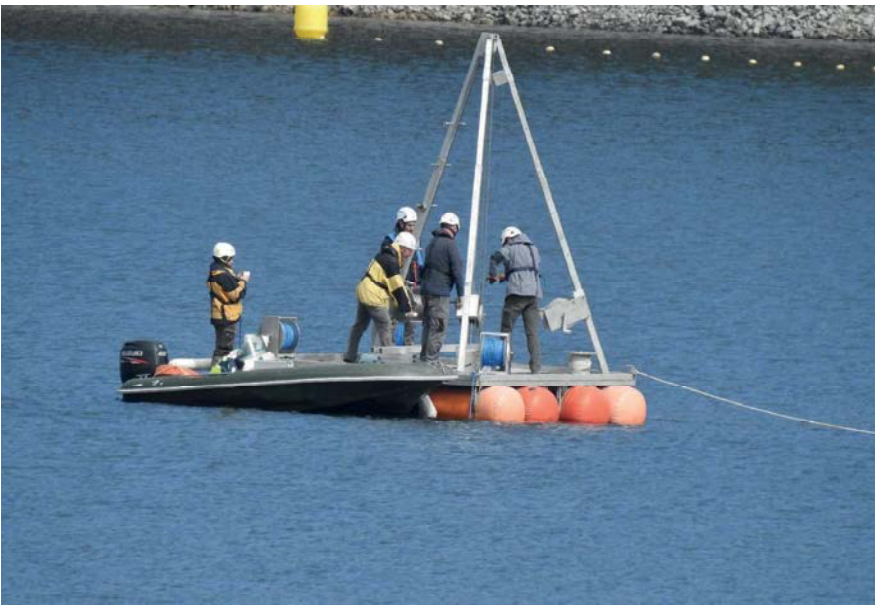
Figure 10 • Le carottage 2020 en cours avec une barge UWITECH (photo Hubert-Marie Piteux).
