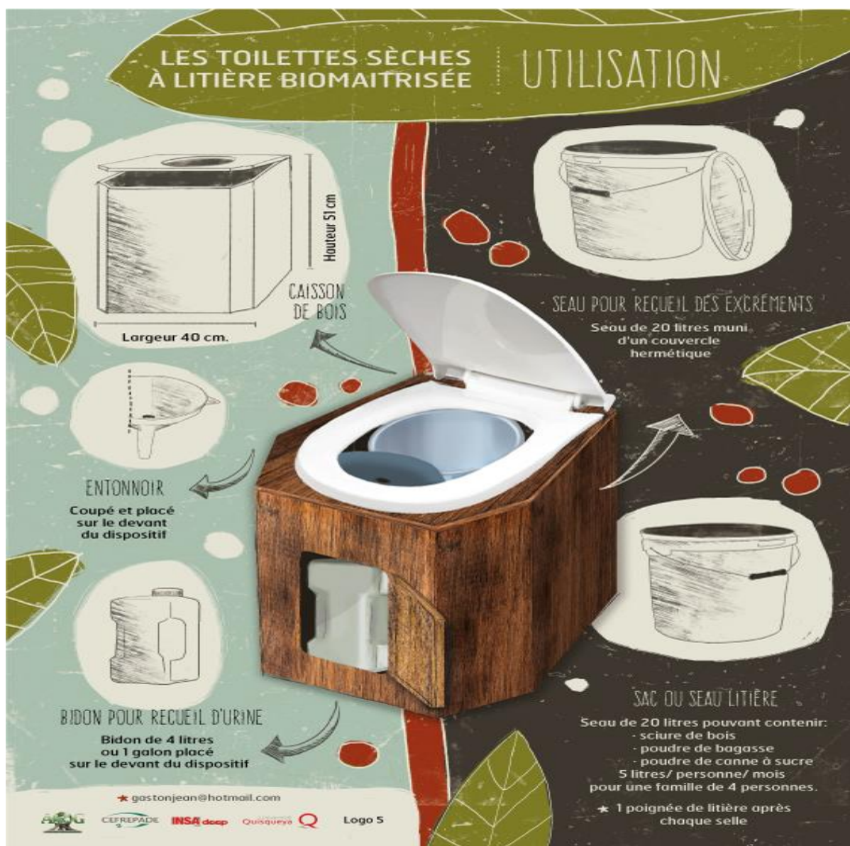
Figure 9a : description d'une toilette sèche à litière (source : plaquette de communication AOG)
