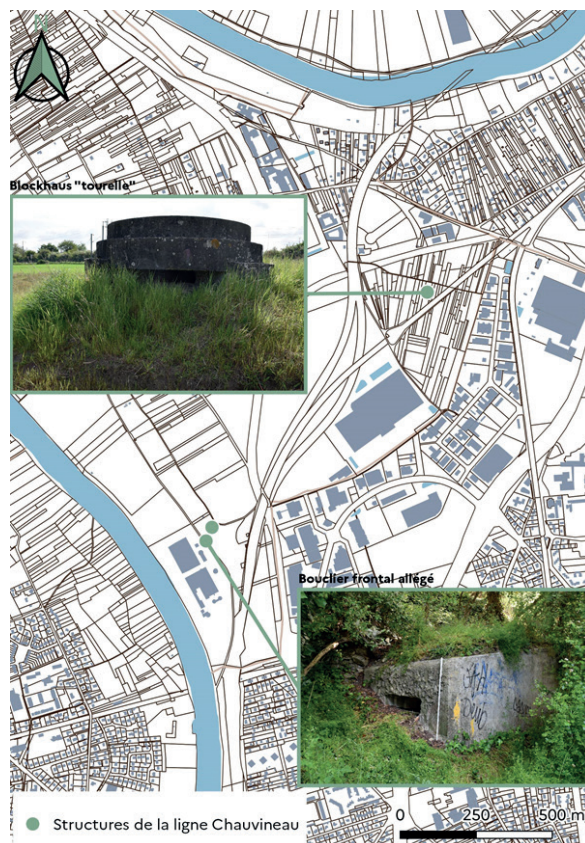
À Neuville-sur-Oise, plan des sites prospectés de la ligne Chauvineau, en haut, tourelle pour mitrailleuse Hotchkiss, en bas, abri bouclier pour canon anti-char de 25 mm. © Pierrick Tigreat
