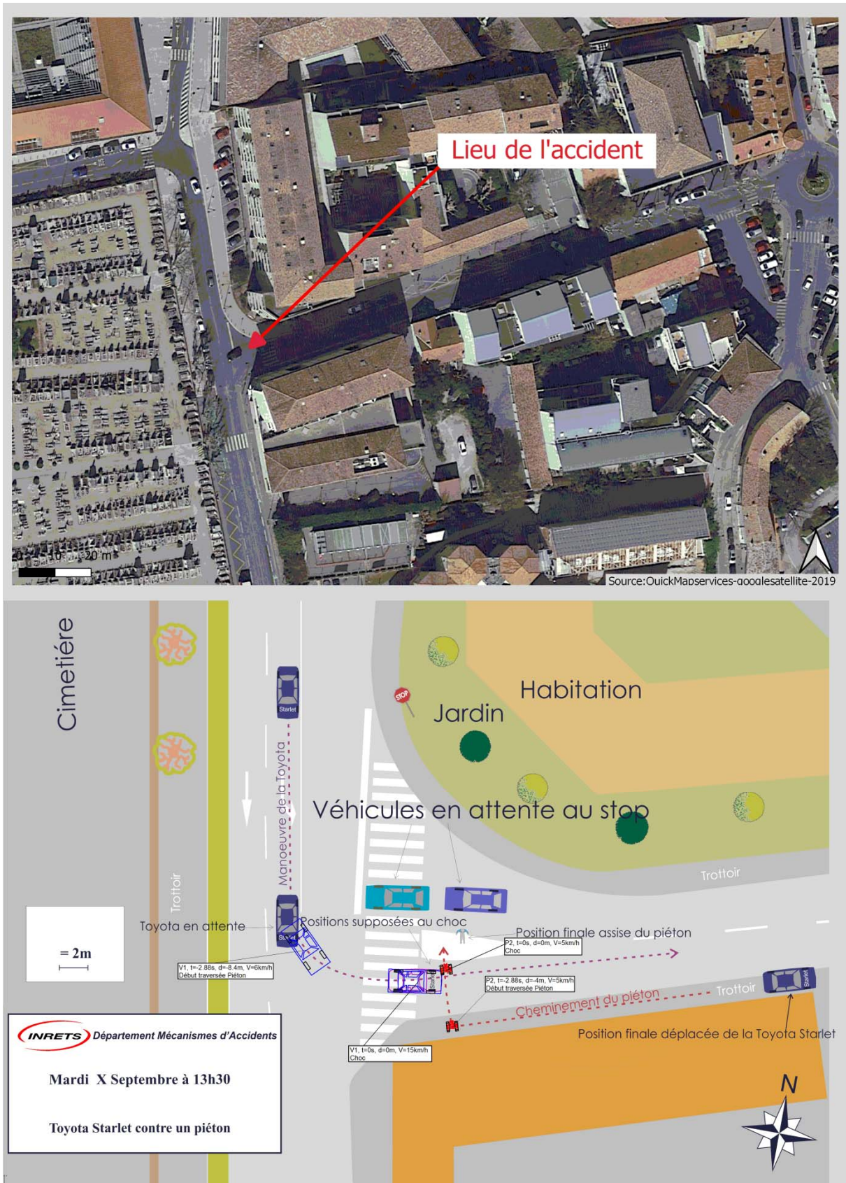
Figure n° 4 : Reconstruction cinématique du cas EDA retenu pour le scénario type 8 - Tourne à gauche
