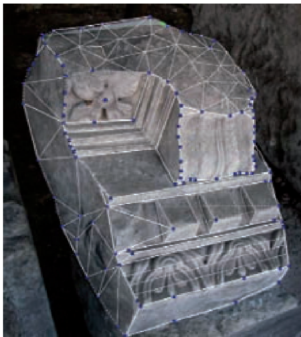
Fig. 3. Modèle filaire du fragment construit à partir des points homologues sélectionnés sur les photographies [aut. F. De Domenico, 2003]
