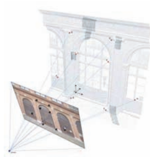
Fig.1. L'orientation d'une photographie sur le nuage de points
