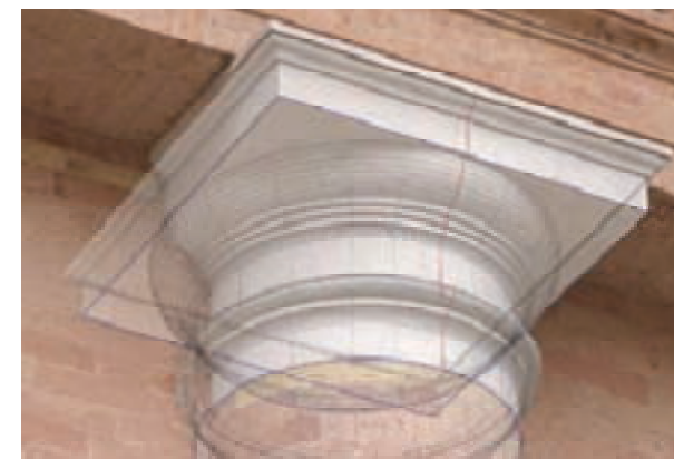
Fig. 11. La primitive instanciée sur une photographie orientée
