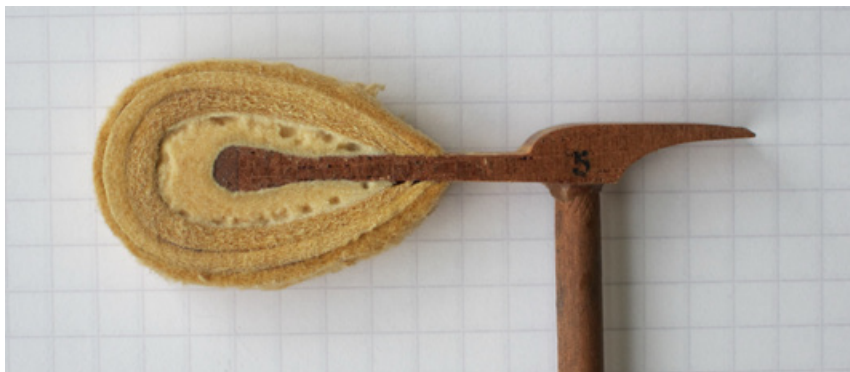
Figure 15 Piano Pleyel, Paris, 1842, musée de la Musique, E.991.16.1. Détail d'un marteau original avec sous-garniture en feutre et garniture de finition en peau chamoisée. © Jean-Claude Battault.
