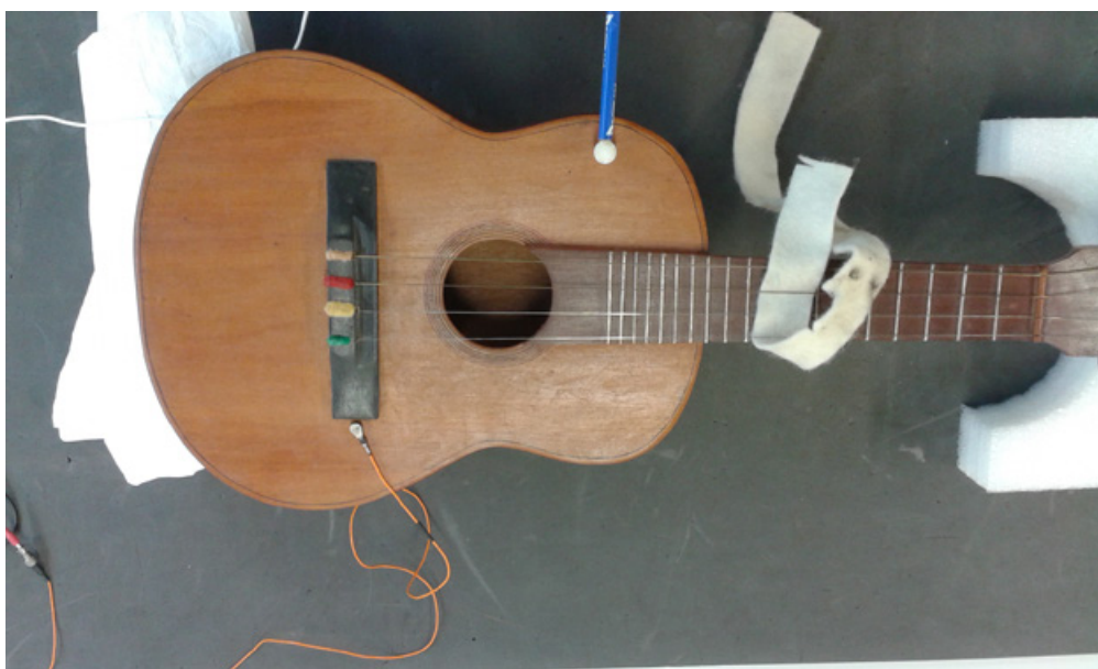
Figure 9 Excitation de la surface d’une guitare avec un marteau d’impact électromagnétique pour l’acquisition du signal. © Cité de la musique–Philharmonie de Paris.
