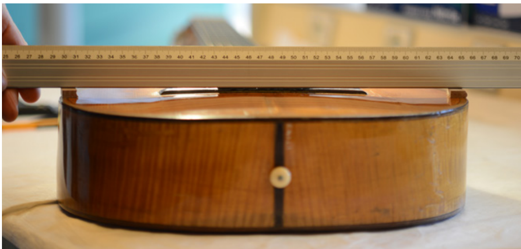
Figure 3 Mesure transversale des contraintes mécaniques imposées à la table d'harmonie avec les cordes sous tension. © Emeline Chevalier.
