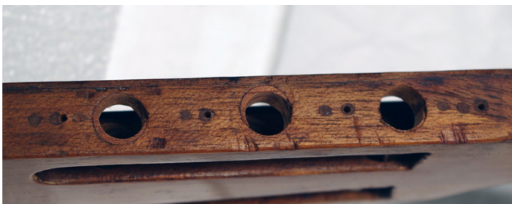
Figure 13 Aperçu de la tête, extérieur côté aiguës après reperçage des perçages de rouleaux de mécaniques. © Emeline Chevalier.
