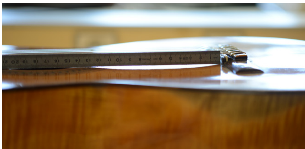
Figure 4 Mesure longitudinale des contraintes mécaniques imposées à la table d'harmonie avec les cordes sous tension. © Emeline Chevalier.
