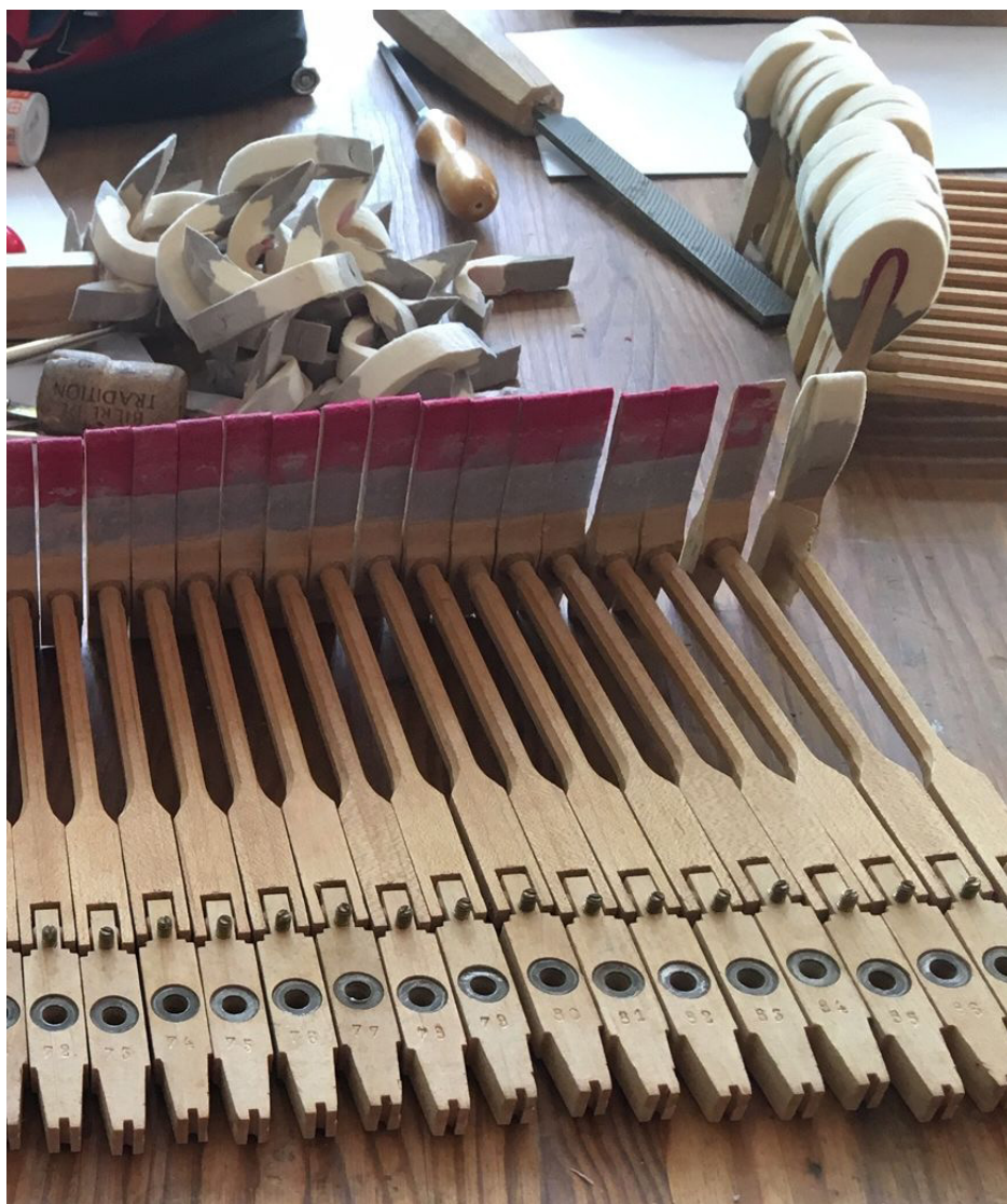
Figure 17 Piano Gaveau, Paris, 1929, musée de la Musique, E.2015.11.1. Préparation des marteaux avant la pose des nouvelles garnitures en feutre. © Jean-Claude Battault.
