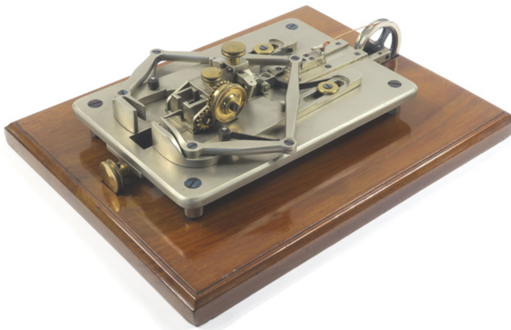
Figure 6 Modèle réduit d'une machine à garnir les marteaux, établissement Pinet, Paris, fin du XIX e siècle, musée de la Musique, E.977.1.2. © Jean-Claude Battault.
