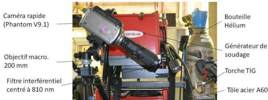
Figure 1 : Photographie du dispositif expérimental : à gauche, la caméra Phantom équipée de l'objectif de 200 mm de focale, à droite, la torche TIG.
