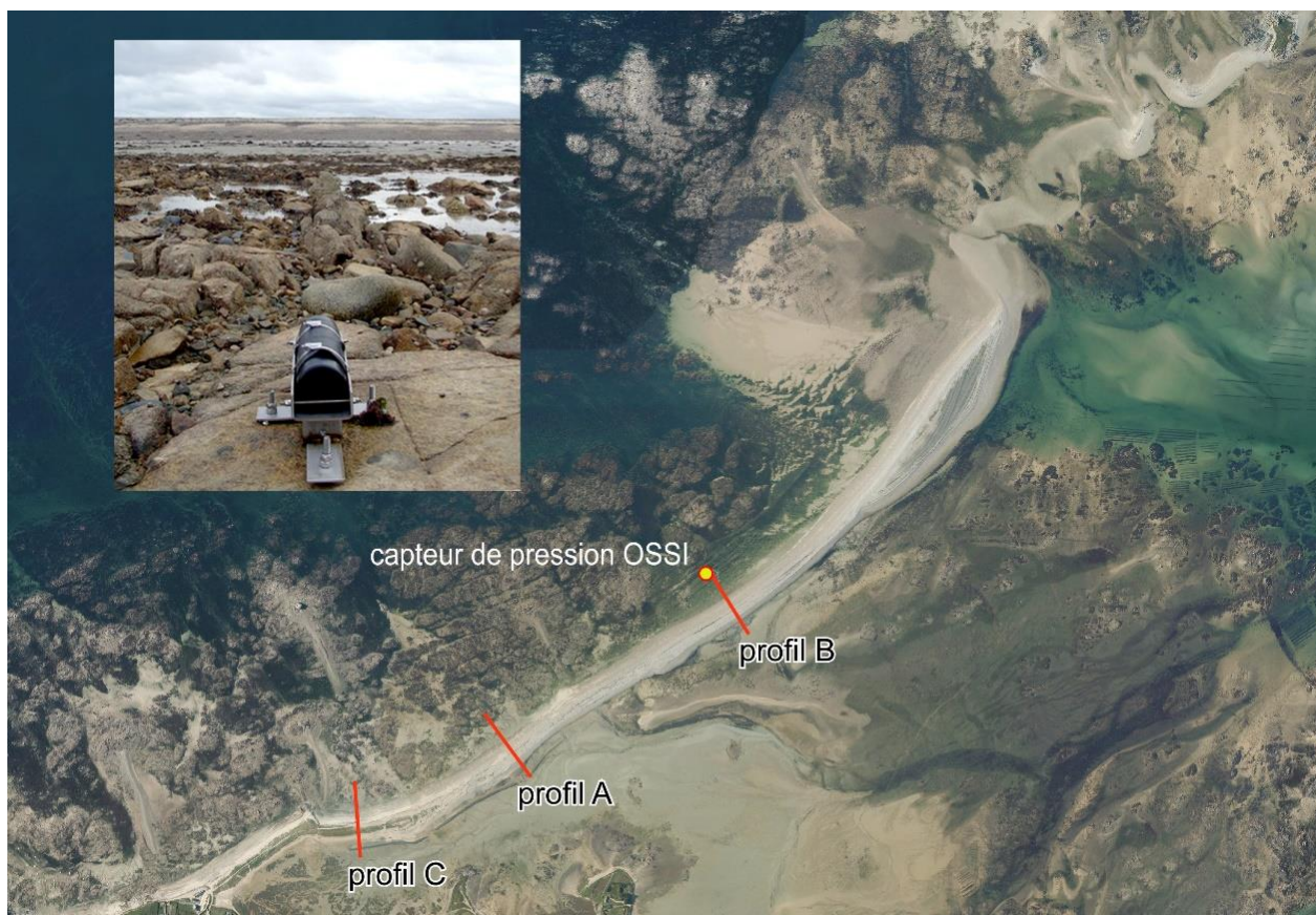
Figure A. Localisation des trois profils de mesures topo-morphologiques et du capteur OSSI de pression de houle et de niveaux d'eau. Ce dernier est installé dans la zone intertidale à -0,461 m NGF. Le fond de carte correspond à l'orthophotographie IGN de 2012, la brèche ouverte au mois de mars 2018 n'est pas présente).
