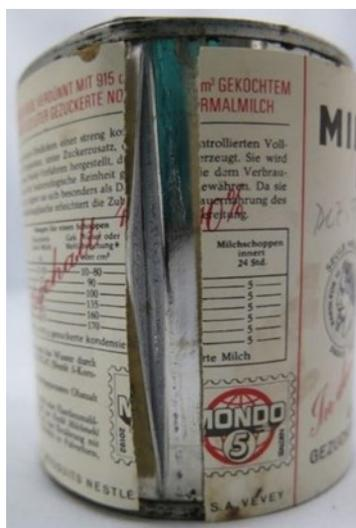
Figure 4. Exemple de gonflement de boîte de conserve à cause du développement d'hydrogène par corrosion
