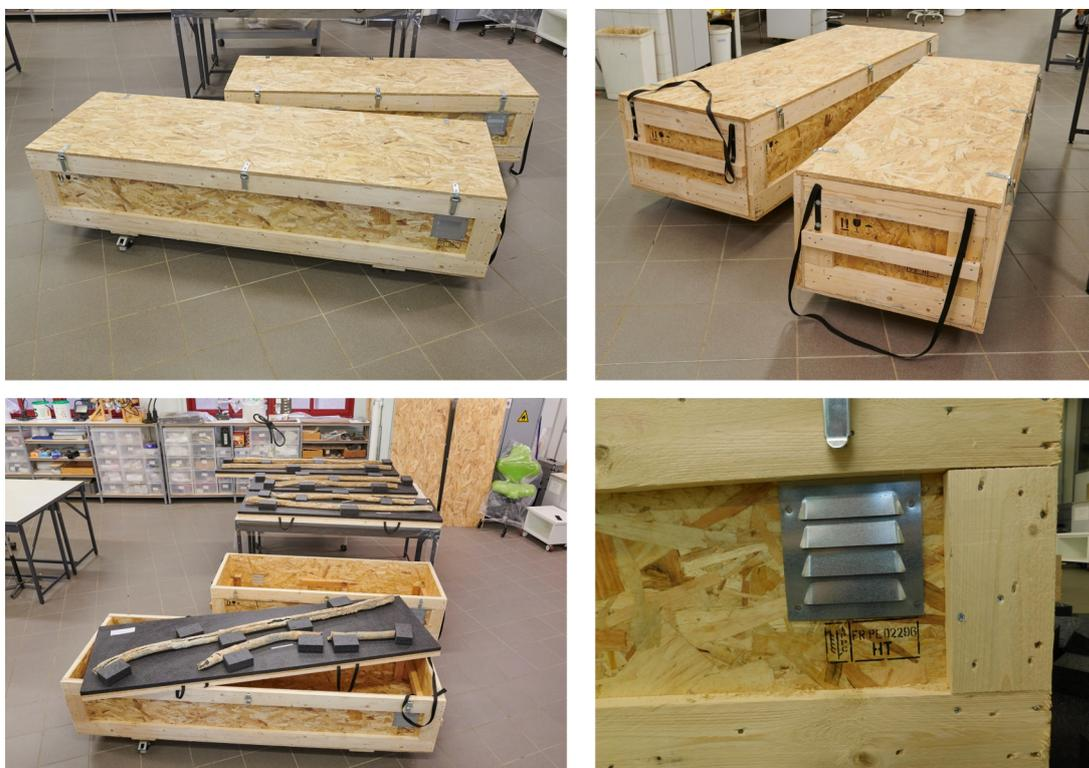
Figure 1. Photographies des caisses en bois (OSB 3) de stockage. ©C. Colonnier, Arc'Antique – Grand Patrimoine de Loire-Atlantique
