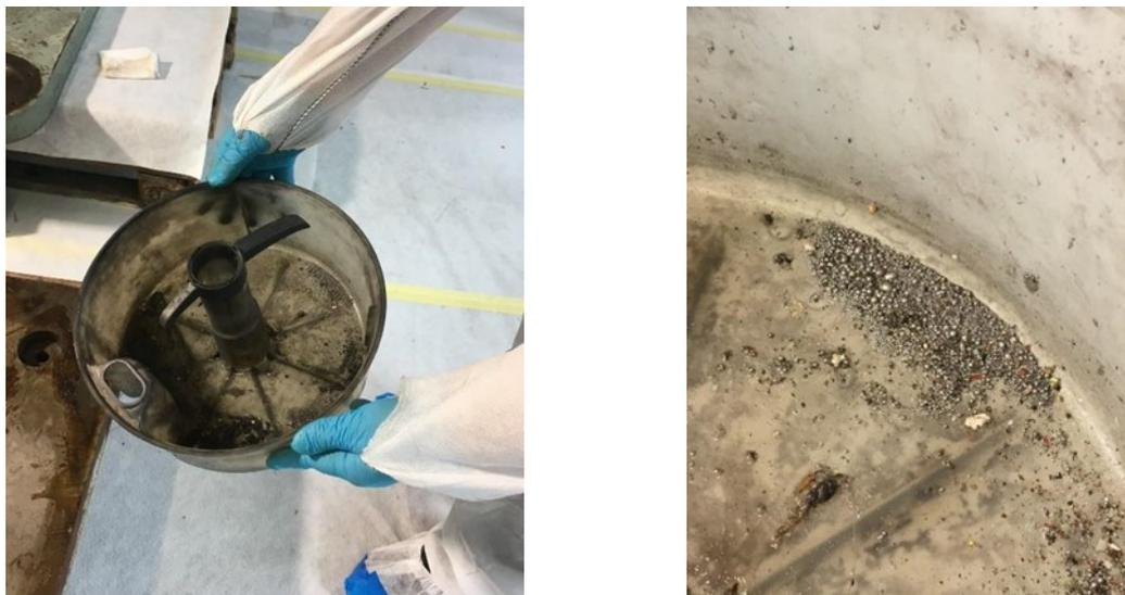
Figure 10. À gauche, le bac de récupération de l'aspirateur à vaporisation d'eau dans la tuyère, après le traitement. À droite, les billes de mercure récoltées parmi les autres poussières
