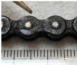
Figure 6. Perles de mercure prises dans la graisse d'une chaîne de transmission. Leur diamètre est de l'ordre de 0,1 à 0,5 mm
