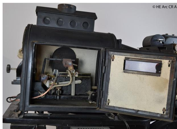
Figure 2. Lampe à arc dans sa lanterne amiantée
