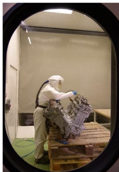
Figure 5. Traitement par micro-sablage dans la cabine à aspiration centralisée. © Materia Viva 2017
