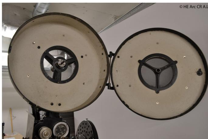
Figure 3. Carter à bobine amiantée, Bauer M7, 1928
