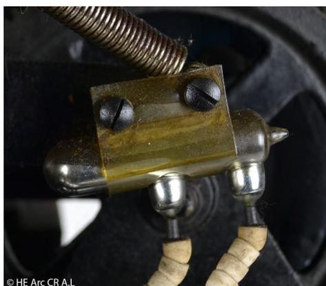
Figure 14. Interrupteur à mercure ©HE Arc CR A.L 2019
