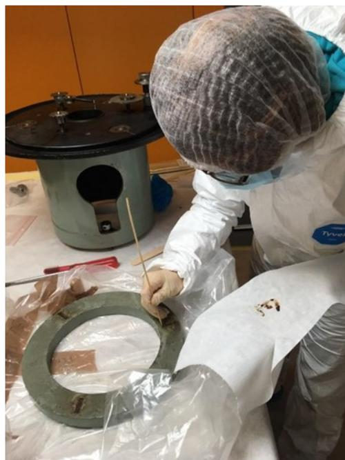
Figure 7. Retrait mécanique des morceaux graisseux retenant des particules de mercure n'ayant pas pu être aspirées
