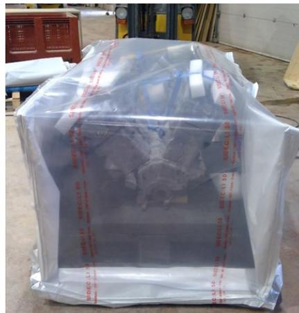
Figure 8. Mise en réserve et création d'une enceinte climatique. © Materia Viva 2017
