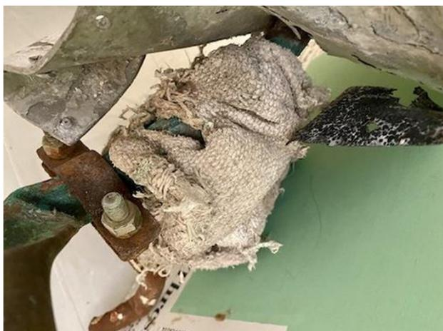
Figure 5. Détail de la gaine avant sectionnement et encapsulation. © Terra Mare Conservation. Courtesy of the Naval History and Heritage Command
