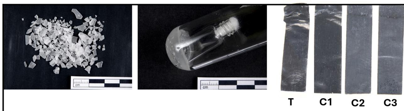
Figure 3. Test de vieillissement selon les conditions du test Oddy du bouche-pores. De gauche à droite : le bouche-pores avant, après 28 jours, coupons métalliques en plomb après 28 jours (T : témoin, C : coupons 1, 2 et 3). © L.Preud'homme, C. Colonnier, Grand Patrimoine de Loire-Atlantique 2024
