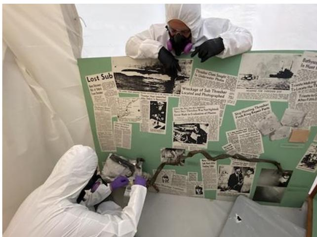
Figure 3. Objet attaché à son panneau explicatif lors de l'examen préliminaire et échantillonnage de l'amiante dans l'enceinte de décontamination. © Terra Mare Conservation. Courtesy of the Naval History and Heritage Command
