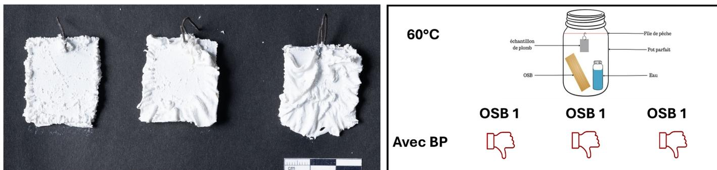
Figure 7. À gauche : coupons métalliques en plomb après avoir été placés dans les pots Parfait®, à 60°C, 100% HR, avec l'OSB 1 + bouche-pores ; à droite : représentation schématique des résultats. © L.Preud'homme, C. Colonnier, Grand Patrimoine de Loire-Atlantique 2024
