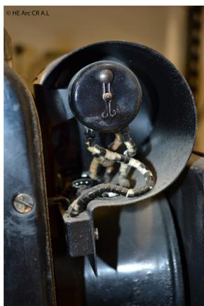
Figure 22. Interrupteur à mercure de sécurité et coupe-feu, Ernemann IV 1937 ©HE Arc CR A.L 2019
