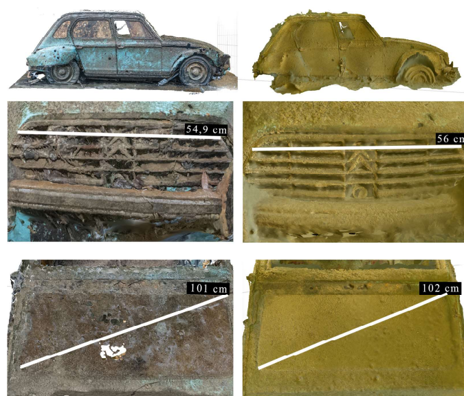
Figure 9 : Comparaison des modélisations 3D d'un véhicule réalisées sous (à droite) et hors de l'eau (à gauche) après extraction de l'épave
