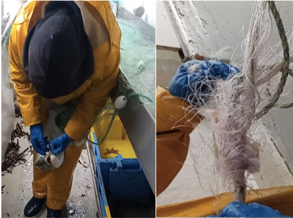
Figure 6 : Activité de démaillage à bord d'un poisson emmêlé dans le filet (photo de gauche), tâche qui exige des matelots un arbitrage entre rapidité et préservation de la qualité de la capture (valorisation financière du poisson démaillé), du filet (éviter la casse des mailles) et de sa propre santé (solllicitations des membres supérieurs dans un espace exigu, répétitivité des actions). Démaillage d'un chignon (morceaux de poissons déchiquetés bloqués dans les mailles) qui demande au matelot d'enchaîner plus d'opérations (Crédits photo : Thiébaud-Rizzoni (2021)).
