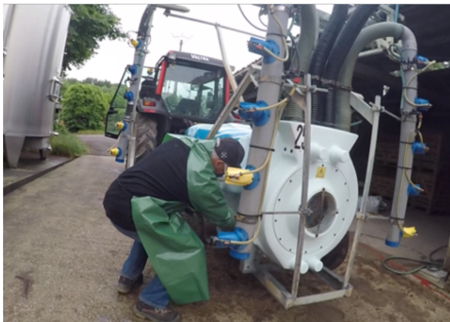
Figure 5 : illustration des vicissitudes d'une conception technocentree non pensée dans l'usage. Système d'ouverture du circuit d'eau positionné à l'arrière du pulvérisateur tracté amenant le viticulteur à se contorsionner et à entrer en contact avec des parties souillées du matériel (Crédits photo : Goutille, 2018)
