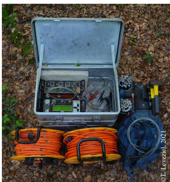
Fig. 13 : Photographie du matériel de prospection électrique.
