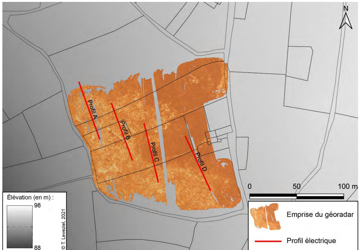
Fig. 59 : Emprise de la prospection géophysique sur la parcelle des Herbrégements, sur fond de cadastre napoléonien vectorisé.
