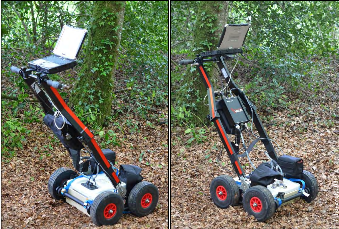
Fig. 18 : Géoradar IDS Himod (antenne duale 200-600 MHz, antenne mono 900 MHz).
