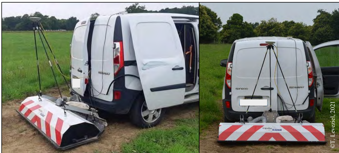
Fig. 20 : Géoradar multifréquences Raptor-45, tracté par un véhicule sur la parcelle 0D 0096.
