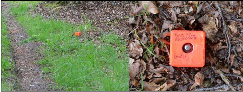
Fig. 7 : Exemple des bornes utilisées pour la mise en station des stations totales topographiques.
