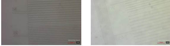
Figure 1 : (a) Image au microscope optique d'un motif de lignes réalisé par lithographie dans un film de résine SU8-3008, (b) Image au microscope optique de la structure précédente dont les espaces en air ont été comblés par du nanocomposite à SCO par centrifugation.
