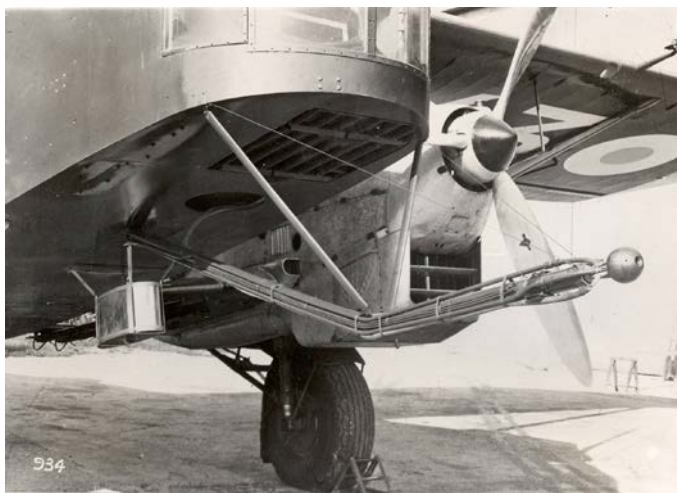
Figure 6.8 L'anémoclinomètre (sphère percée de trous) monté à l'avant du fuselage de l'avion-laboratoire Potez de la Commission de la turbulence atmosphérique.
