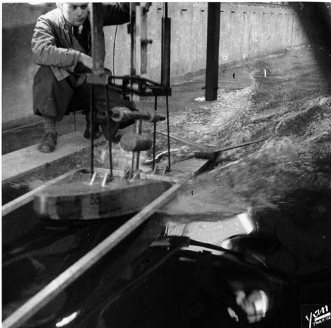
Figure 6.2 Maquette d'une coque d'hydravion (Laté 631) dans le canal droit. Arch. IMFT.
