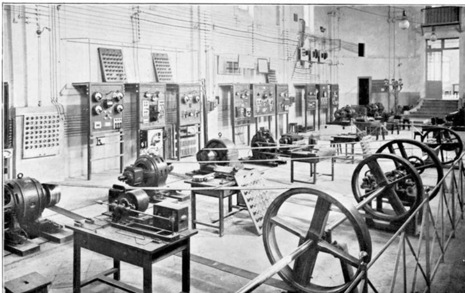
Figure 4.6 Salle des machines électriques des 2 e et 3 e années, côté génératrices : dynamos et excitatrices à courant continu, et alternateurs triphasés.
