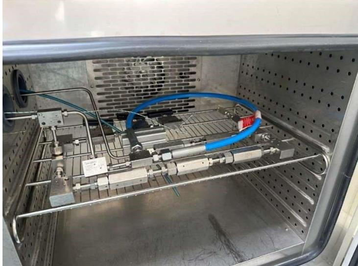
Fig. 6. Installation de cyclage des composants d'hydrogène sous haute pression ( $0 \leftrightarrow 70$  Mpa) d'après [36]
