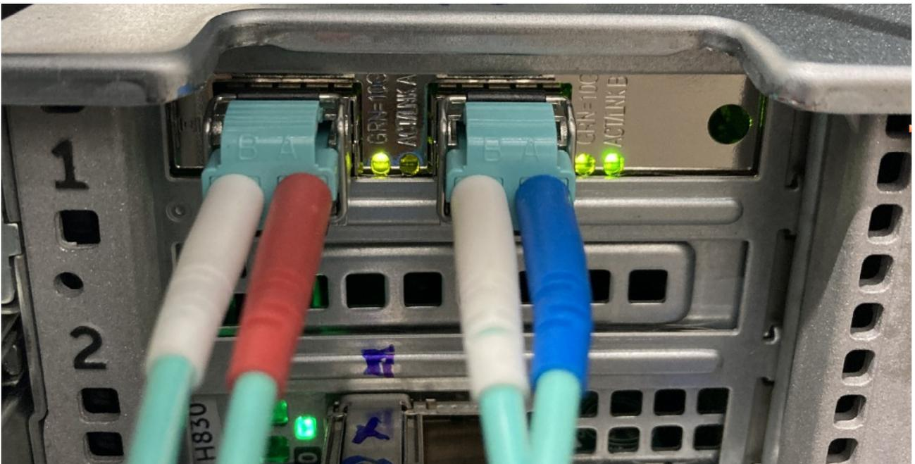
*Figure 7 - Interconnexion des interfaces de la sonde sur le TAP*
