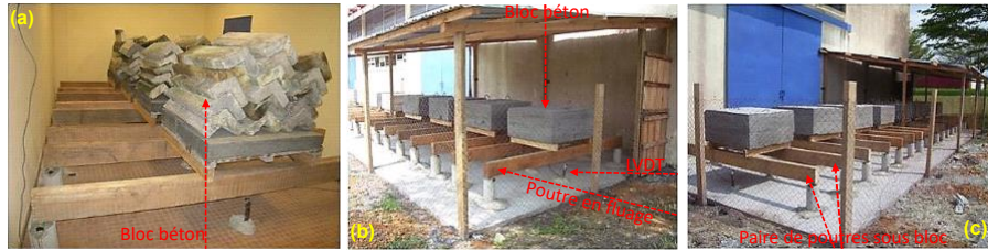
Fig. 5. Poutre tropicales exposées en environnement climatisé (a), en environnement extérieur abrité (b) et environnement extérieur non abrité (c).
