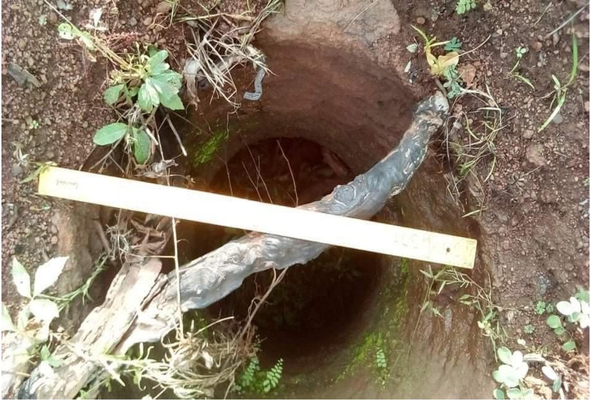
Photo7 : Un puit de mine de section circulaire sur le site de Waaba (Prise de vue N.G. TIDOUO KOUAGOU, 2020)
