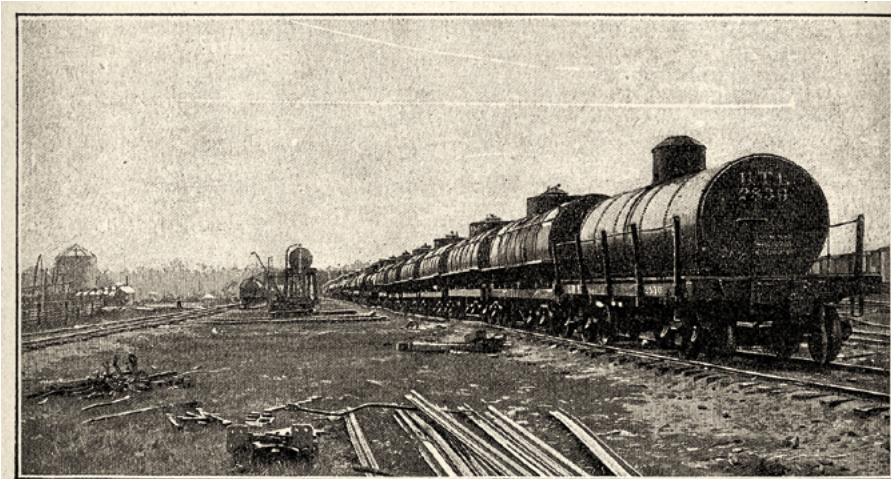
COMMENT ON TRANSPORTE LE PÉTROLE. — UN TRAIN DE WAGONS-CITERNES DANS UNE STATION AFFECTÉE AU CHARGEMENT.
