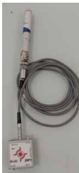
FIGURE 26 – Dispositif d'acquisition utilisé en forêt à Voellerdingen. En bas : dispositif électronique central de type DIEFI. En haut : magnétomètre fluxgate tri-axial (Bartington MAG03)
