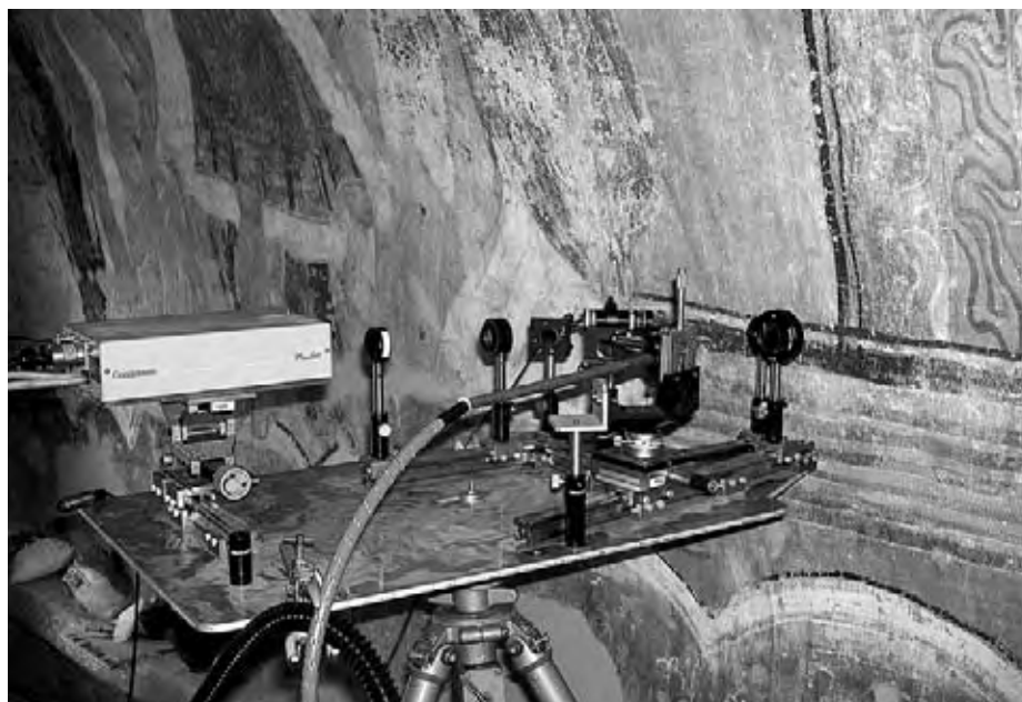
Le LIBS portable du Laboratoire de recherche des monuments historiques lors de la restauration des peintures murales de l'abbaye de Saint-Savin-sur-Gartempe (Vienne).
