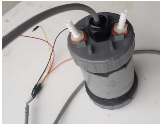
Figure 7 Boîtier de calibration des capteurs
