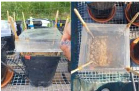
Photo 9 - Couvercles en plastique transparent permettant de protéger les pots S de l'apport d'eau par les précipitations
