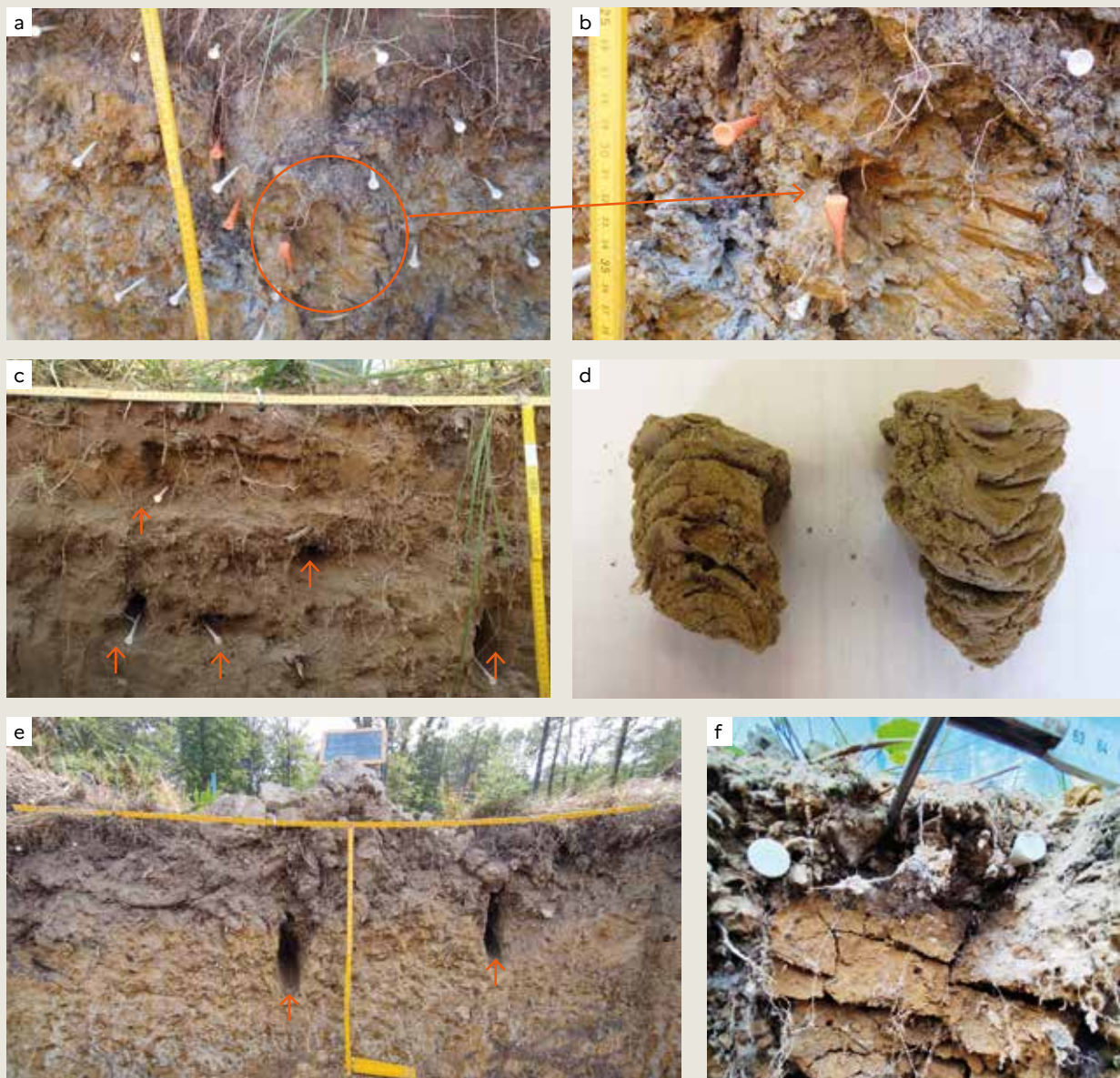
↑ Figure 3. (a) et (b) Apparition de zones préférentielles de circulation d'eau qui peut provoquer une augmentation localisée de l'engorgement en présence d'un plancher imperméable dû à l'argile ou à un horizon compact ; (c) et (e) création de vides suite au passage de l'outil dans le sol ; (d) apparition d'une structure lamellaire issue d'une réorganisation horizontale de la porosité, causée par le roulage des portes outils qui tassent les horizons de surface ; (f) phénomènes de lissage et de plissage suite au passage de l'outil dans le sol.
