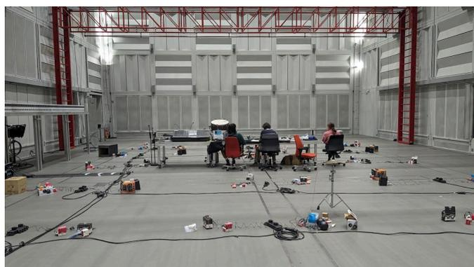
Le système expérimental développé dans le cadre du projet de recherche DOTS<sup>2</sup> est composé d'un ensemble d'agents, chacun composé : d'un Raspberry Pi, d'un *shield* audio Hifiberry, d'une batterie portable, d'une petite enceinte, d'une LED et d'un microphone. Cette configuration matérielle, relativement générique et polyvalente dans un contexte expérimental, se veut ouverte et
