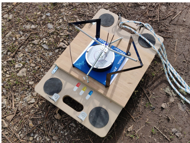
Sismodule topographique (2021), chariot trainé par l'artiste-marcheur qui permet d'enregistrer les vibrations sur un support fixe ou tournant (principe du tachygraphe).
