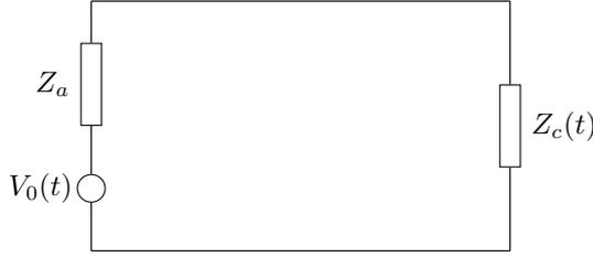
**Figure 1. Circuit équivalent d'une antenne à diffusion minimale avec une tension en circuit ouvert  $V_0(t)$  et chargée par une puce RFID  $Z_c(t)$  sortie par un signal modulé.**
