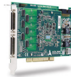
FIG. 1.14 – Carte d' acquisition haute densité. 96 voies analogiques 12 bits 3 Méch./s.
