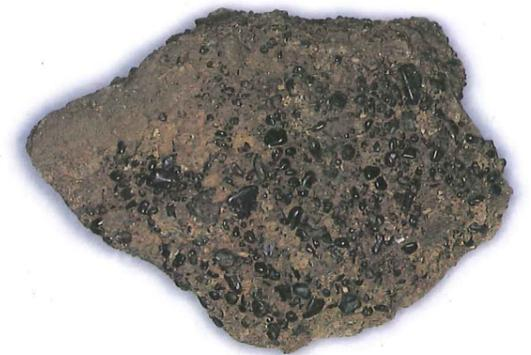
Bloc de limonite en pisolithes agglomérées dans du sable provenant d'un gouffre. Les pisolithes sont des concrétions sphériques de diamètre supérieur à 2 mm, constituées de couches concentriques d'oxydes de fer.
