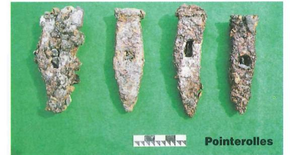
Les coins en bois et en fer ont été utilisés avec la masse dans toutes les mines de fer. Le coin servait à éclater les blocs volumineux au front de taille ou abattus au sol.
