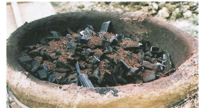
**Bas foyer expérimental : orifice supérieur du four après chargement : le charbon de bois est mélangé au minerai de fer concassé.**
