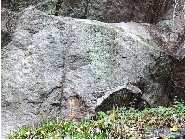
Trace de trou de barre à mine présent sur un bloc de granite encore en place dans le front de taille.
