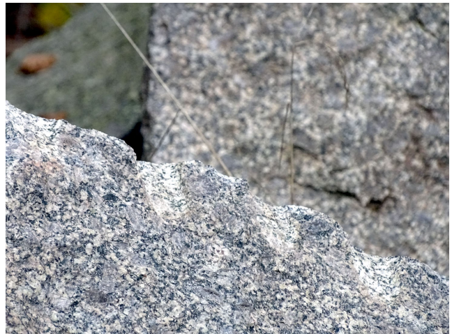
Chute de granite comportant une ligne de mortaises. Ces mortaises permettaient la découpe du bloc à la taille désirée avant son transport vers la graniterie.
