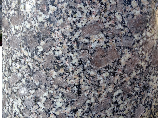
Echantillon de granit photographié sur la colonne de la fontaine installée au centre du village de Miellin. C'est bien le même type de granit.
