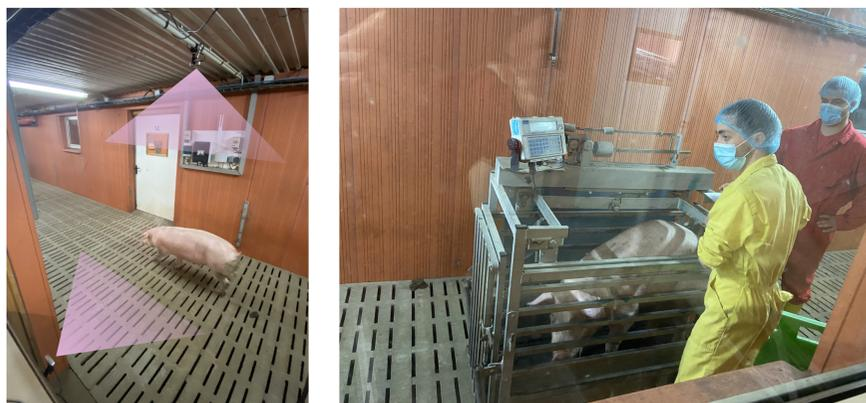
Dispositif expérimental avec les deux caméras installées orthogonalement dans le couloir (gauche) et la plateforme de pesage (droite).
