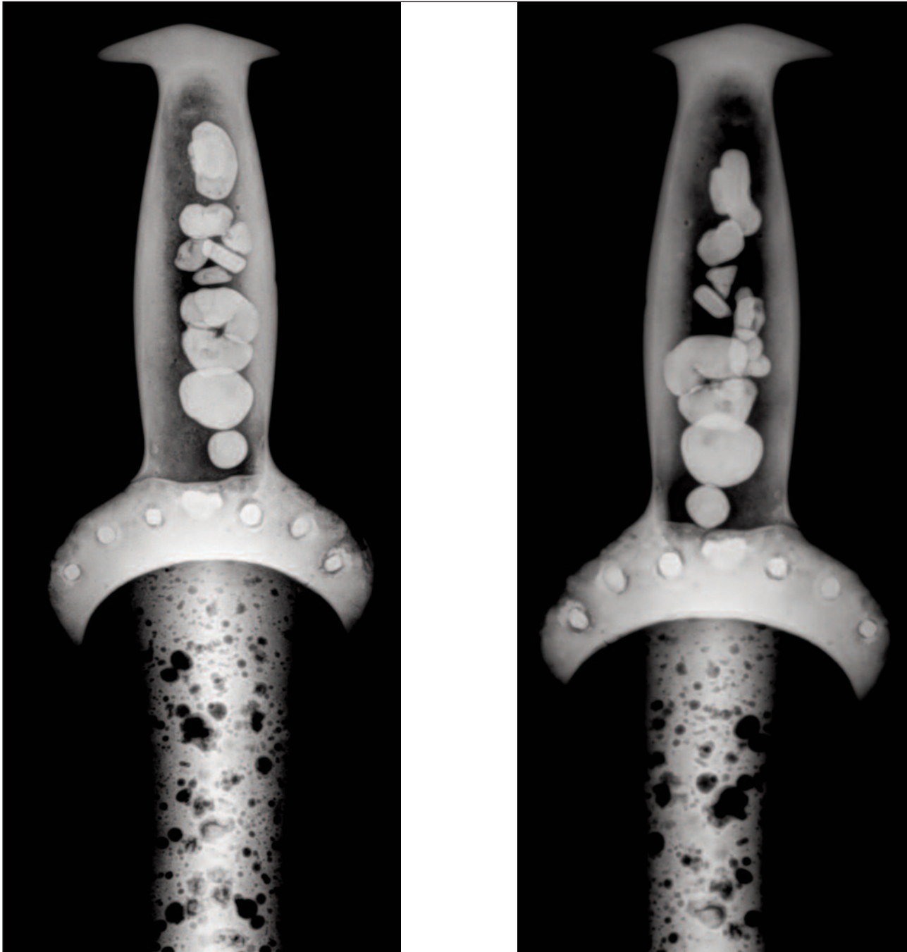
Figure 5 - Deux radiographies prises au niveau du rivetage de la lame sur la poignée. (© Clichés radiographiques réalisés par Valentin Meyer, Cabinet vétérinaire de Trélissac).
