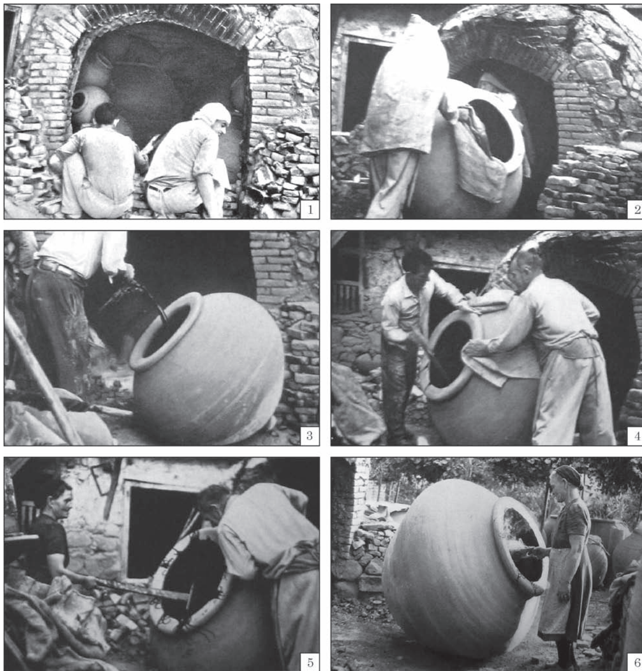
Рис. 35. Печь для обжига пифосов на Кипре, завершающие этапы производства сосудов, 1961 г.: 1 — замуровывание загруженной гончарной печи; 2 — извлечение пифосов из горячей печи; 3—5 — смоление сосудов; 6 — ритуальное обдымливание пифоса, по (Hampe, Winter 1962, Taf. 41; 37).
