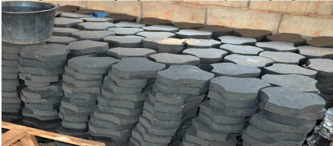
Figure 10b : Pavés en plastique issus de déchets recyclés à Ouagadougou
