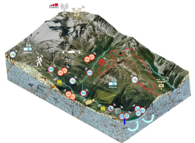
Illustration schématique de ce que pourrait être un observatoire TERRA FORMA, un site combinant capteurs fixes et mobiles communicants et plateformes de communication. Source: A. Elger, TERRA FORMA
