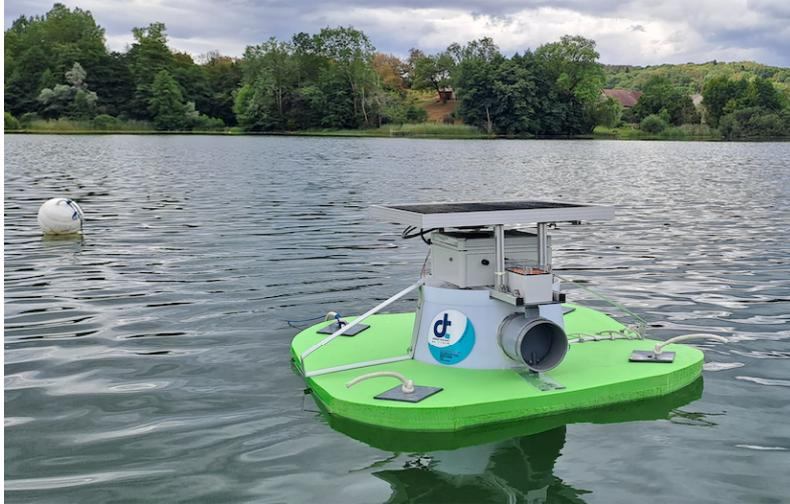
Fig. 8 : Prototype CFA V2 sur le lac de Chavoley (Ain), station centrale, en août 2023.
