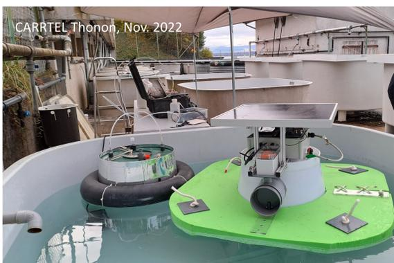
Comparaison du prototype V2 avec une chambre manuelle (Licor LI 820)
