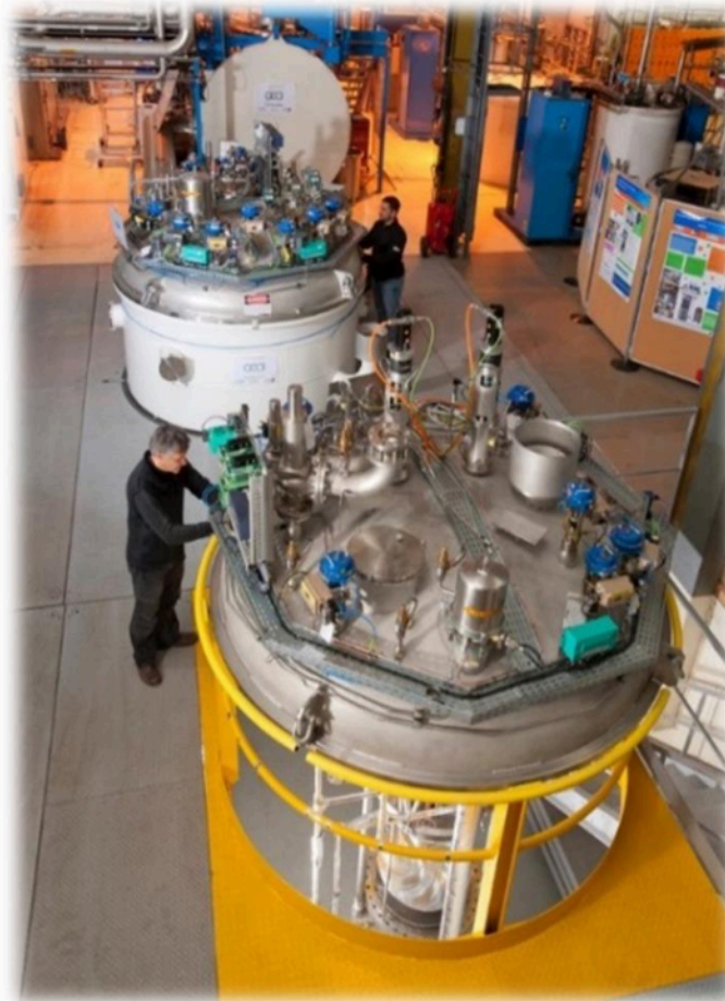
Adaptation du Cryostat Multi-Test pour les tests de performance du prototype HX-D2
