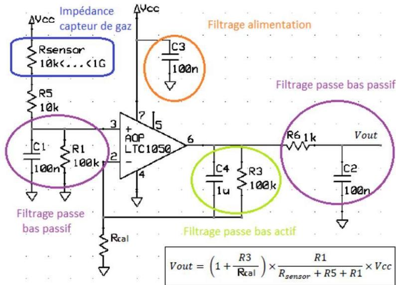
Fig.2. Circuit d'adaptation d'impédance du capteur de gaz.
