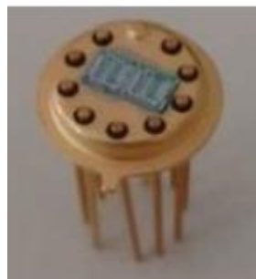
Fig.6. Montage de l'amplificateur CMOS hybride personnalisé de 2mm x 4mm sur support TO5.
